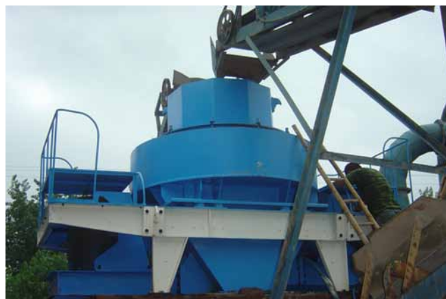
新型制砂机VSI-8518在安徽六安安装调试
