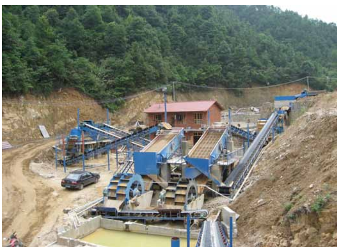
湖南浏阳花岗岩时产100方人工制砂生产线
