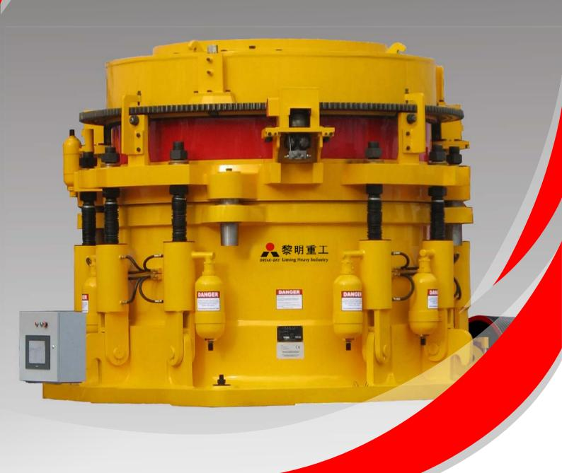
HP系列高效液压圆锥破碎机是我公司引进德国最新技术而开发的具有世界先进水平的高能圆锥破碎机。该机通过采用粒间层压原理设计的特殊破碎腔及与之相匹配的转速,取代传统的单颗粒破碎原理,实现对物料的选择性破碎,破碎粒度均匀。双向过铁释放液压缸能够让铁块顺利通过破碎腔,并且在发生过铁及瞬时闷车的情况下,能液压起顶,自动排料,避免了弹簧圆锥破碎机需要停机维护的操作。破碎腔体采用高性能非接触式迷宫密封件,提高了阻挡粉尘的可靠性,降低了铁污染和设备的磨损周期,加上机身携带的独特稀油润滑系统,大大提高了设备使用寿命。
